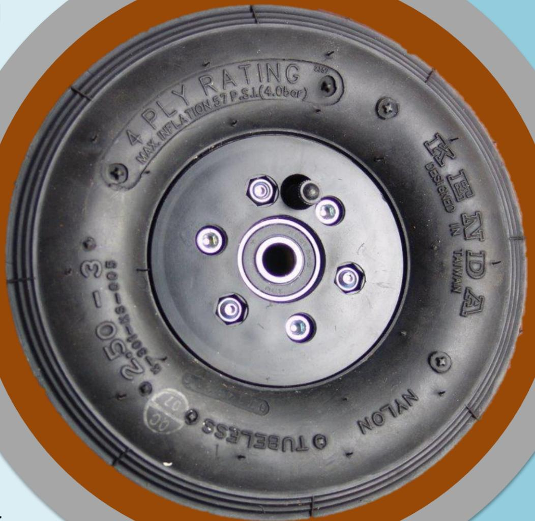
Einen kleinen Reifen auf eine einteilige Felge zu montieren ist aufwändig. Häufig wird dabei sogar der Schlauch beschädigt. Eine geteilte Felge erleichtert die Montage erheblich, auch weil nur Standardwerkzeuge benötigt werden.
